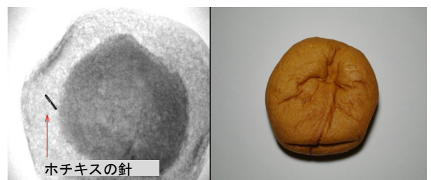
写真1 アンドーナツ(右)にホチキスの針を入れて撮ったX線透過画像(左)
