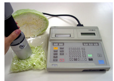
色差計によるカット野菜の色調変化の測定
