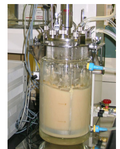
ジャーフェーマンター (微生物大量培養装置)
